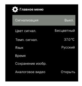
**Температура сигнализации**: установите температуру сигнализации. Этот пункт действителен только тогда, когда тип сигнализации установлен на сигнализацию высокой или низкой температуры.
