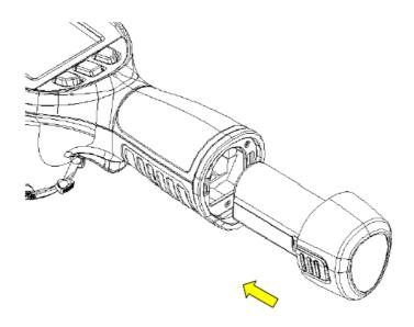
Вставьте батарейный блок непосредственно в отсек для батареи, и вы сможете использовать устройство после того, как вы услышите «щелчок»; нажмите на крючки с обеих сторон блока батареи, чтобы извлечь батарею.
