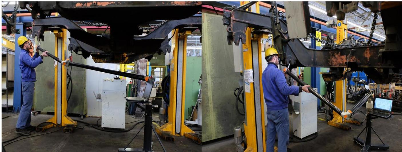
**7-осная Мастер ЭВА** подходит не только для процессов контроля контактным датчиком, но и для лазерного сканирования! Для метрологического контроля и реинжиниринга
